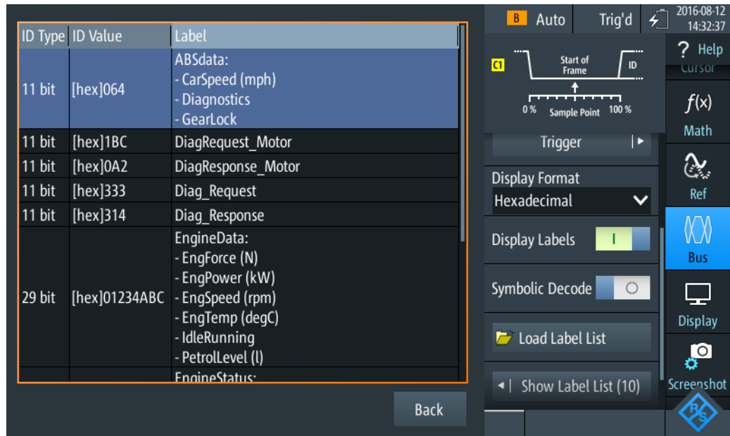
Bild 9-27: Anzeige einer DBC-Datei für CAN
