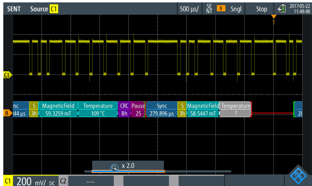
Bild 9-42: SENT-Decodierungsergebnisse mit Umsetzung über Label-Liste
