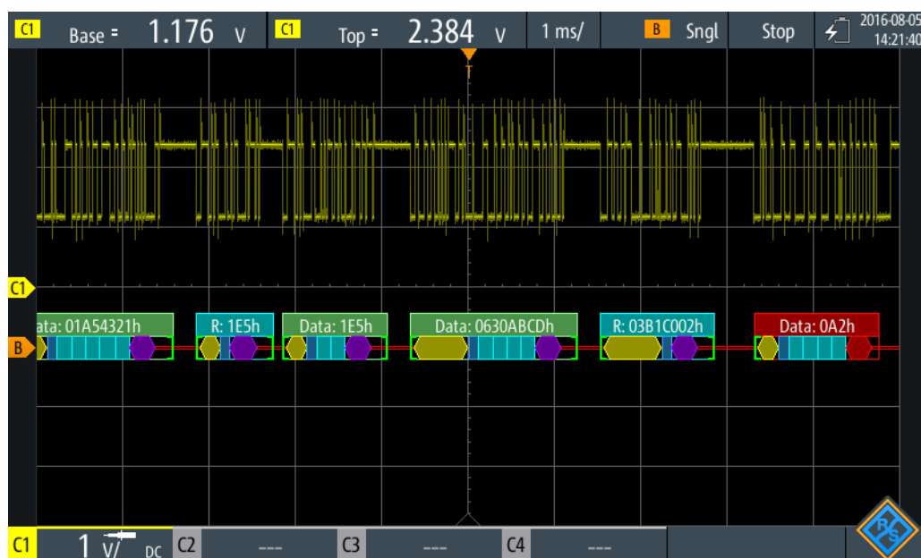
Bild 9-30: Wabenanzeige eines decodierten CAN-Signals, getriggert auf Adresse 0630ABCD (hex)
