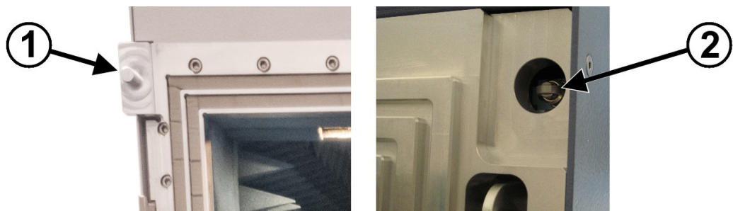
รูป 4-6: เขี้ยวอินเทอร์ลอคตัวบนสำหรับกลไกการลอคประตู
