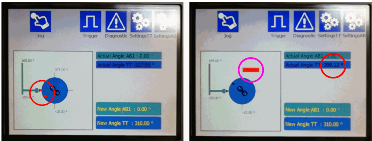
รูป 7-11: ในระหว่างการอ้างอิง ไม่ต้องสนใจลูกศรสีแดง (ซ้าย) และมุมของแขนหมุนที่อยู่นอกช่วงตั้งแต่ -15° ถึง +375° (ขวา)
