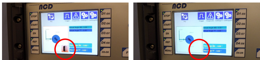
Bild 4-8: Förreglingssymbolen på styrskärmen för lägesställarna
