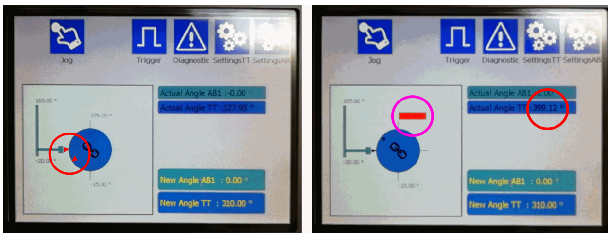
Bild 7-11: Under referenspunktskörning, ignorera de röda pilarna (vänster) och vinklar för svängskivan som går utöver området från -15° till +375° (höger)
