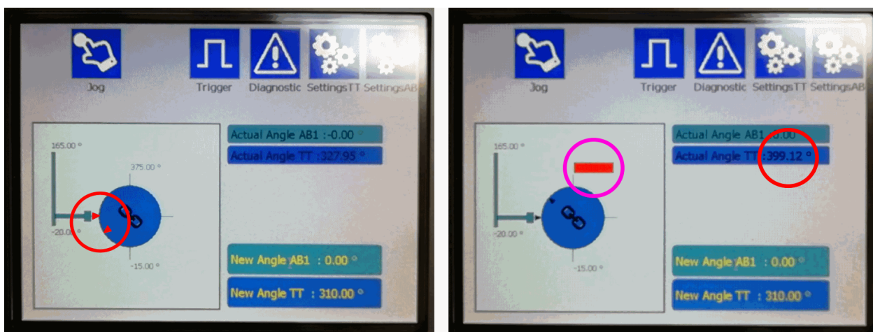
Figure 7-11 : Au cours du référencement, ignorez les flèches rouges (à gauche) et les angles du plateau rotatif étant en dehors de la plage -15^{\circ} à +375^{\circ} (à droite)
