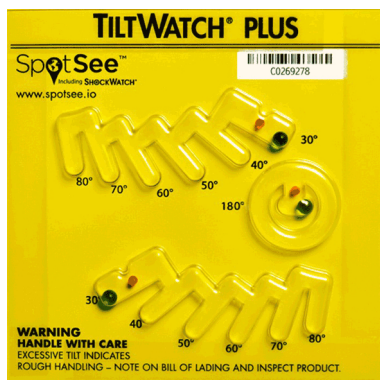
Figure 6-2 : Indicateur d'inclinaison, OK si les billes sont en positions originales
