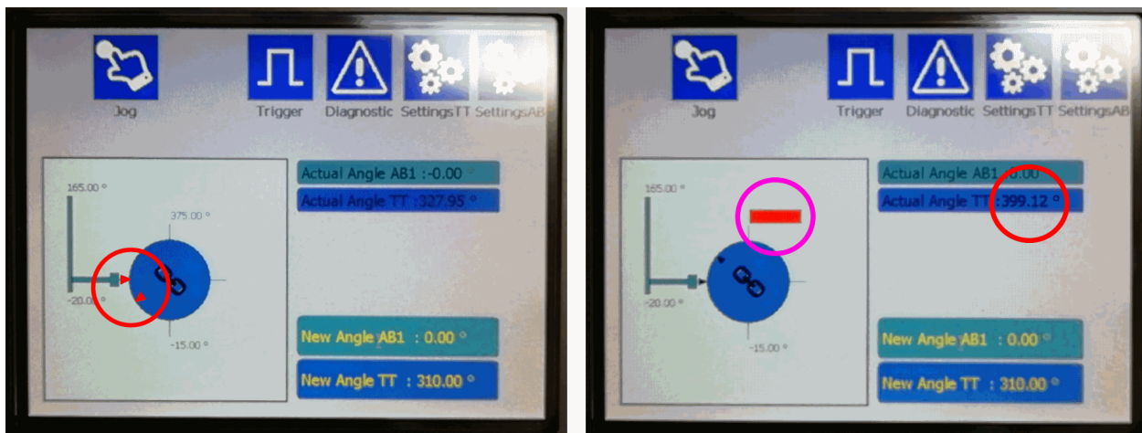
Figura 7-11: Durante la referenciación puede ignorar las flechas rojas (a la izquierda) y los ángulos de la mesa giratoria fuera del margen de -15^\circ a +375^\circ (a la derecha)
