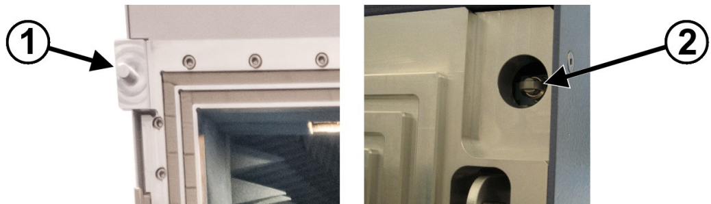
Figura 4-6: Llave de bloqueo superior para el mecanismo de bloqueo de la puerta
