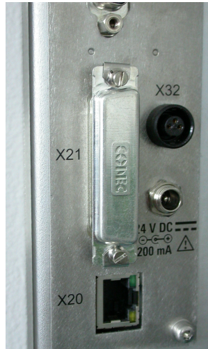
Şekil 6-10: D-Sub 25-pin bağlantı ucunu kapatan güvenlik kapağı [X21]
