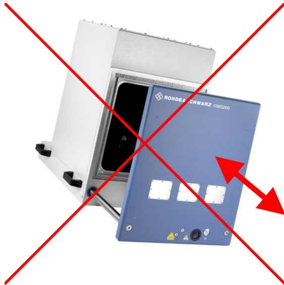
Hình 5-1: Không nâng cửa không đảm bảo an toàn: nguy cơ về chuyển động không thể kiểm soát được của cửa
