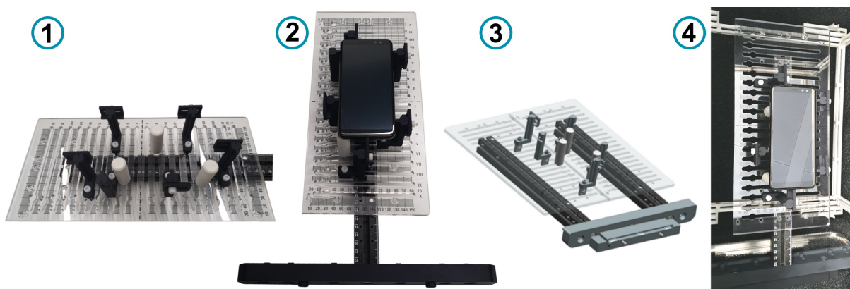
Рис. 7-11: R&S CMQ-B715A опция «DUT Clamp 2», номер для заказа 1537.6261.02
