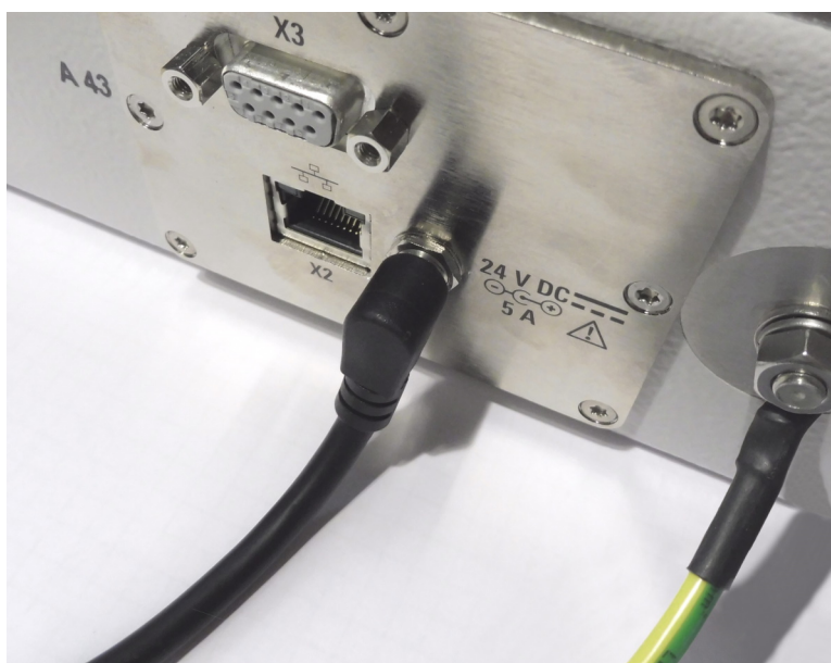
Figură 7-1: Conectorul sursei alimentare cu energie electrică de 24 V cc [X1] (central)
