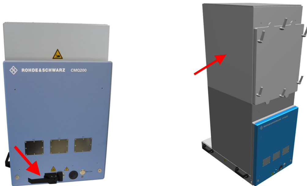
그림 4-3: 수동 도어 잠버(왼쪽), 높이 연장 장치 부착 챔버(오른쪽)
