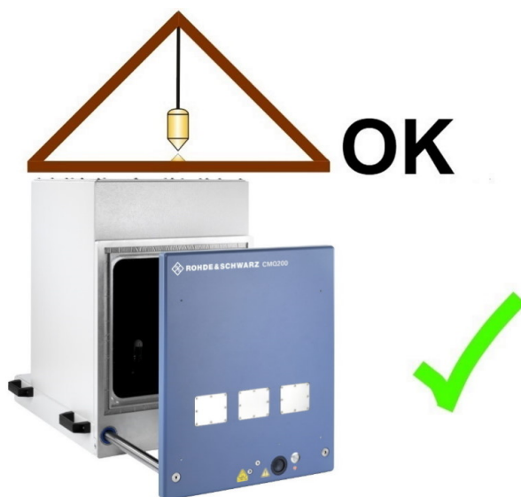
Figure 6-1 : Position horizontale de la chambre
