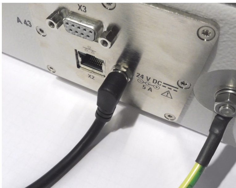
Kuva 7-1: 24 V :n tasavirtalähteen liitin [X1] (keskellä)
