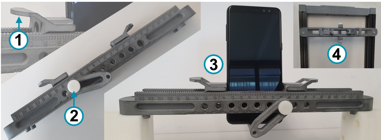
Kuva 7-10: vaihtoehto R&S CMQ-B714A DUT Clamp 1 tilausnro 1537.6255.02
