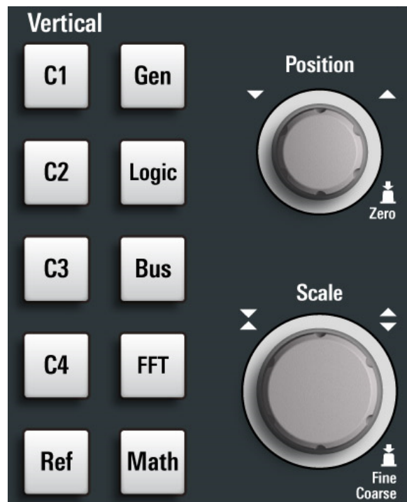
图 5-4: R&S MXO 5 的垂直控件，具有 4 个输入通道
