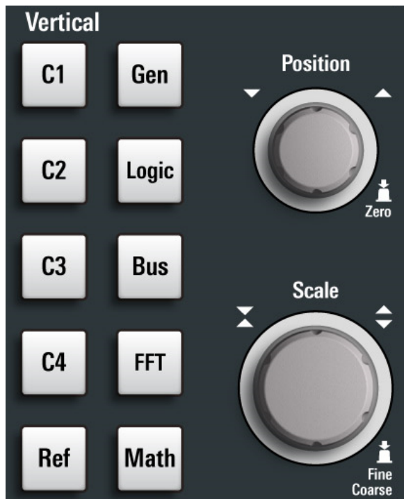
그림 5-4: 4개 입력 채널을 이용한 MXO 5 수직 컨트롤
