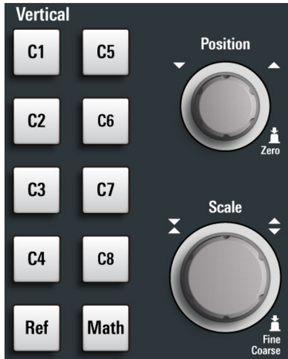
그림 5-5: 8개 입력 채널을 이용한 MXO 5 수직 컨트롤
