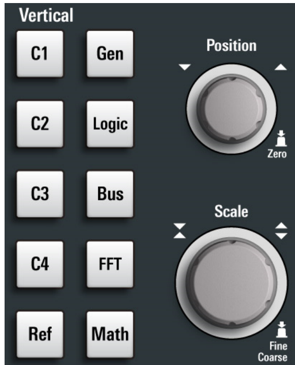
그림 5-4: 4개 입력 채널을 이용한 R&S MXO 5 Vertical 제어
