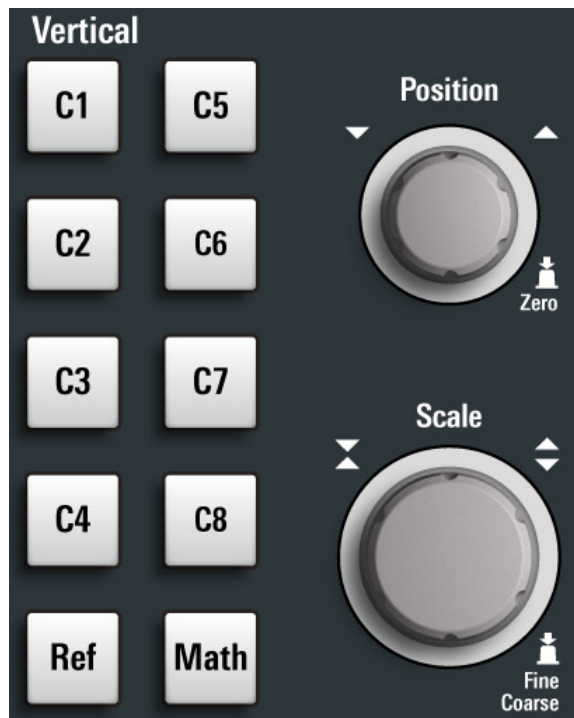
그림 5-5: 8개 입력 채널을 이용한 R&S MXO 5 Vertical 제어
