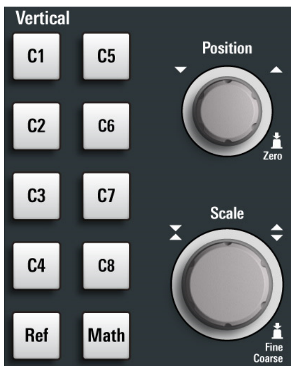
図 5-5: 8つの入力チャンネルを搭載したMXO 5の垂直軸コントロール
