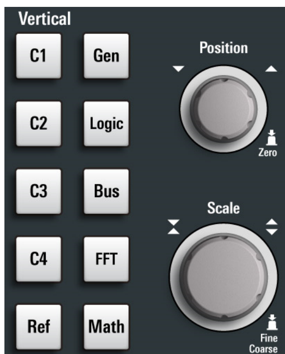
図 5-4: 4つの入力チャンネルを搭載したMXO 5の垂直軸コントロール
