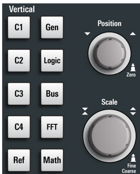
Figura 5-4: Controles verticales del Osciloscopio MXO 5 con 4 canales de entrada
