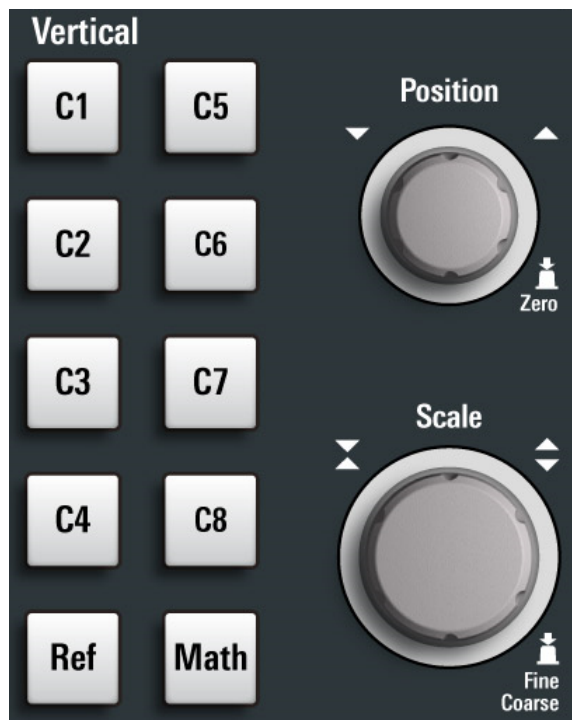
Figura 5-5: Controles verticales del Osciloscopio R&S MXO 5 con 8 canales de entrada
