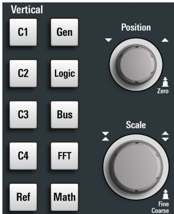
Figura 5-4: Controles verticales del Osciloscopio R&S MXO 5 con 4 canales de entrada
