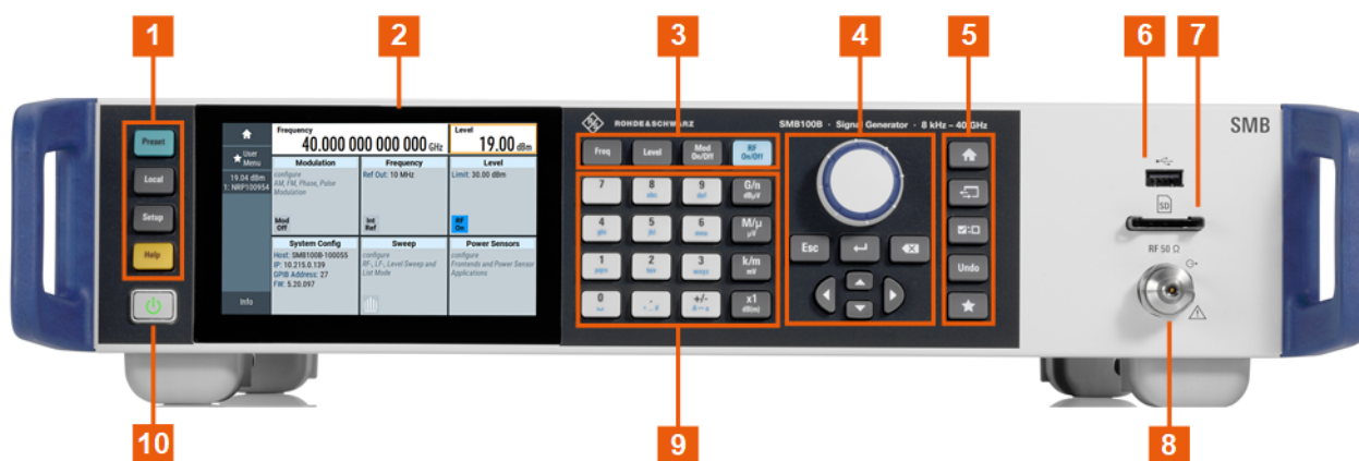
図 5-2: R&S SMB100B マイクロ波信号発生器のフロントパネルの外観
