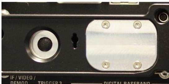
이 출력 커넥터는 R&S FSW-B517 옵션이 설치되어 있고 활성 상태인 경우 최대 600 MHz 샘플 레이트의 I/Q 데이터 스트림을 공급합니다.
