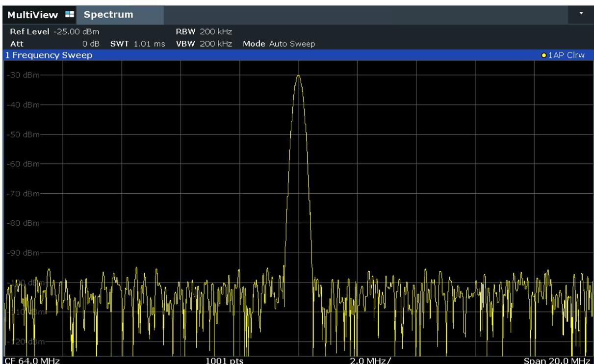
**Bild 6-2:** Kalibriersignal bei optimierten Einstellungen für die Anzeige
