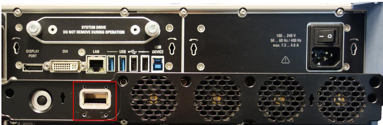
Entfernen Sie bei Bedarf die Metallabdeckung vom Anschluss an der Rückseite des R&S FSW.
