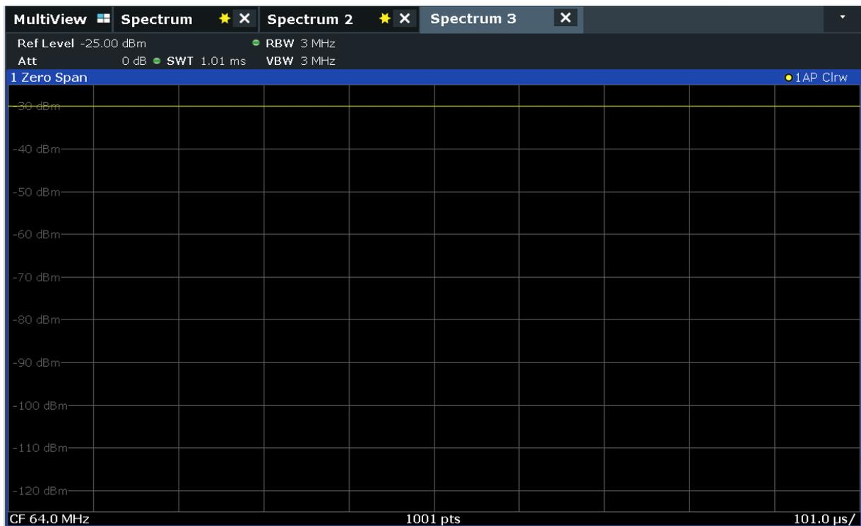
**Bild 6-7: Anzeige des Kalibriersignals im Zeitbereich**
