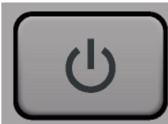
Die Power-Taste befindet sich links unten auf der Frontplatte. Sie dient zum Hochfahren und Herunterfahren des Geräts.
