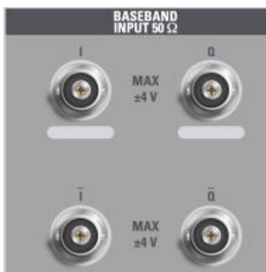
Die oberen BNC-Anschlüsse BASEBAND INPUT I und BASEBAND INPUT Q dienen als Eingang für:
