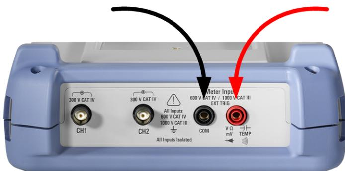
圖 4-1: 電錶輸入端 (Meter Input) 用以連接測試引線
