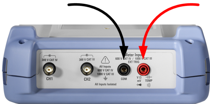
图 4-1: 连接测试引线到万用表输入端
