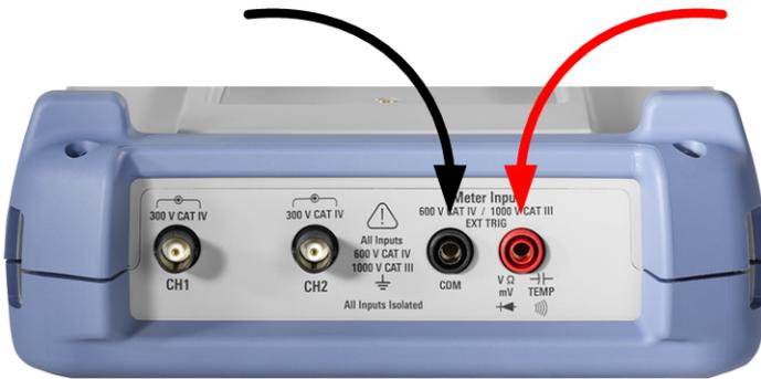
그림 4-1: 테스트 리드 연결용 미터 입력 단자
