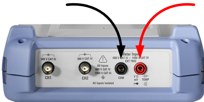
Figure 4-1 : Entrées du multimètre pour connecter les fils de test
