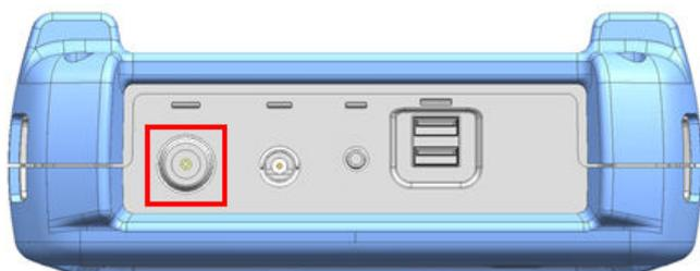
Ein Kabel oder Messobjekt wird mit einem N-Stecker an den HF-Eingang angeschlossen. Der Anschluss des Messobjekts an den R&S Spectrum Rider kann bei Bedarf über ein Kabel erfolgen.
