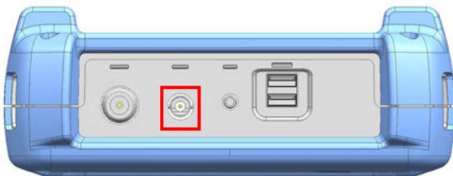
Der BNC-Anschluss kann für verschiedene Anwendungen genutzt werden. Er unterstützt ein externes Trigger-Signal oder ein externes Referenzsignal.
