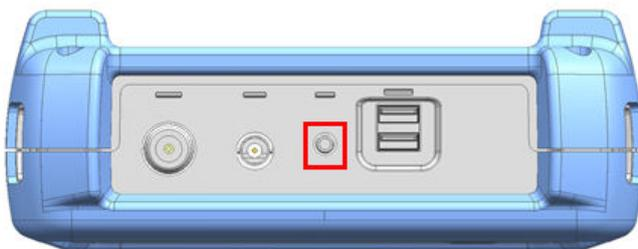
Der Innenwiderstand des Anschlusses beträgt etwa 10  $\Omega$ .
