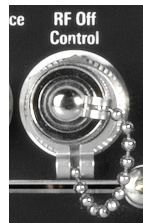
図 4-2: RF Off Control、ショート終端
