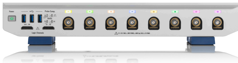
图2:许多示波器会权衡启用的通道数量和每个通道可用的最大存储
