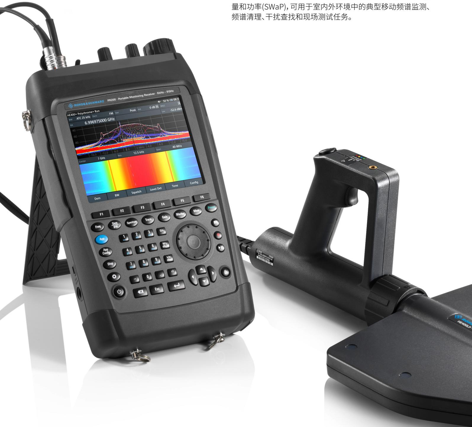
除了多彩频谱显示和扫描速度达60 GHz/s的快速频谱概览外, R&S®PR200还具备模拟解调和多种信号测量功能, 包括电平测量、场强测量和符合ITU标准的调制参数测量。R&S®PR200还提供时域分析功能, 能够同时在频域和时域中显示信号。当与时分复用网络中的特定时隙匹配时, 门限频谱显示应用甚至可通过仅在可调时域门限内计算实时频谱来发现难以探测的干扰信号。
