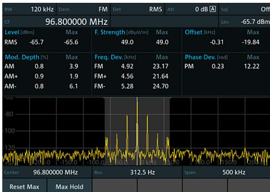
在一个视图中显示符合ITU标准的AM调制深度、FM频率偏移和PM相位偏移测量。
