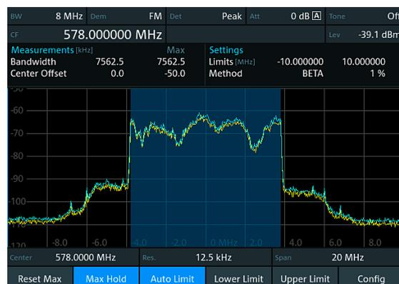
Medição automática da largura de banda ocupada de um sinal DVB-T (método  $\beta$  %).
