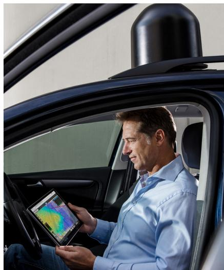
Radiogoniometria móvel com a antena radiogoniométrica compacta R&S®ADD207 e o software de radiolocalização automática R&S®MobileLocator para PC.
