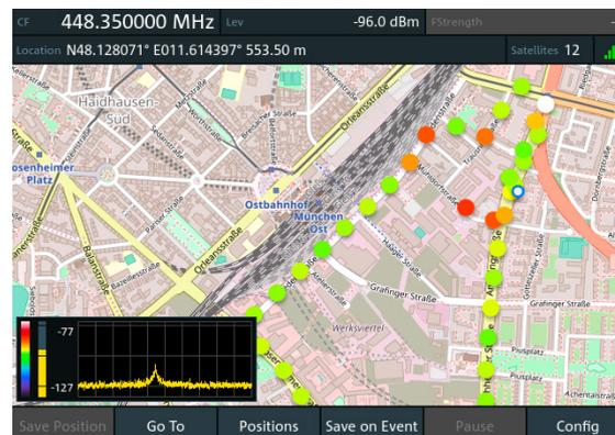
Medições de cobertura por meio de mapeamento de nível com visualização de espectro integrada.
