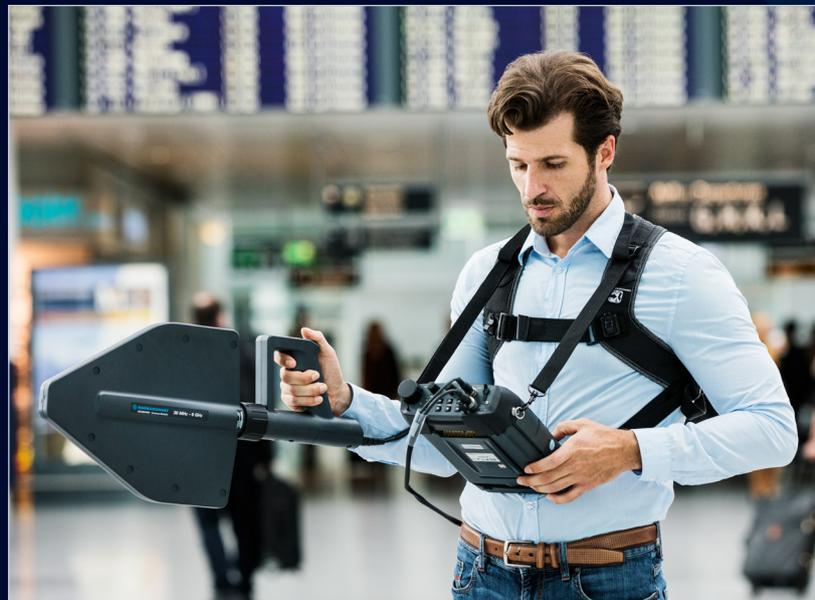
Radiogoniometria com determinação manual da posição com o R&S®PR200 e o R&S®HE400.
