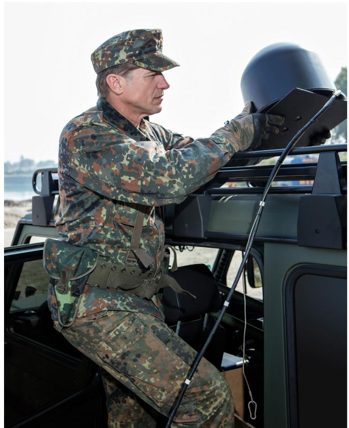
Radiogoniometria automática com a antena radiogoniométrica compacta da Rohde & Schwarz em um suporte magnético (requer a opção de software R&S®CS-DF).
