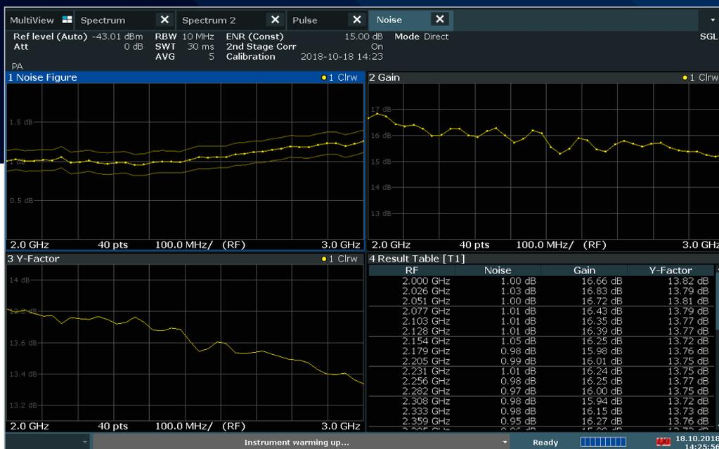
Abb. 1: Rauschzahl- und Verstärkungsmessung mit der Applikationsfirmware R&S®FSx-K30 Rauschzahlmessungen. Neben der Ergebnistabelle, der Anzeige der Messkurven für die Rauschzahl, der Verstärkung und dem Y-Faktor kann die Messunsicherheit für die Rauschzahl berechnet und angezeigt werden.
