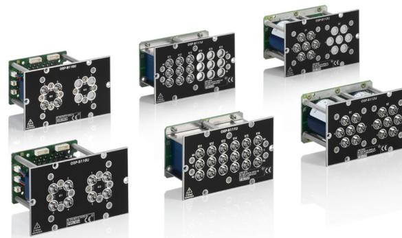
Module mit SPDT-, DPDT- und SP6T-Relais bis 50 GHz.
