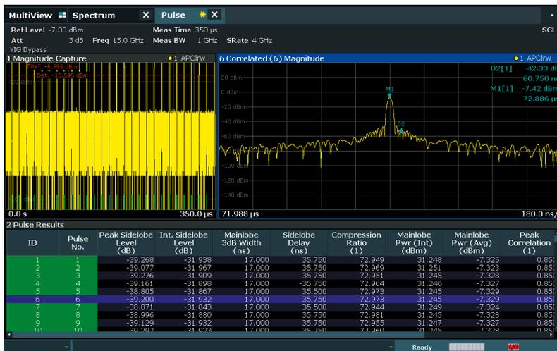
R&S®FSW-K6S オプションにより、チャープパルスのパルス圧縮パラメータと相関振幅ディスプレイが表示されます。
