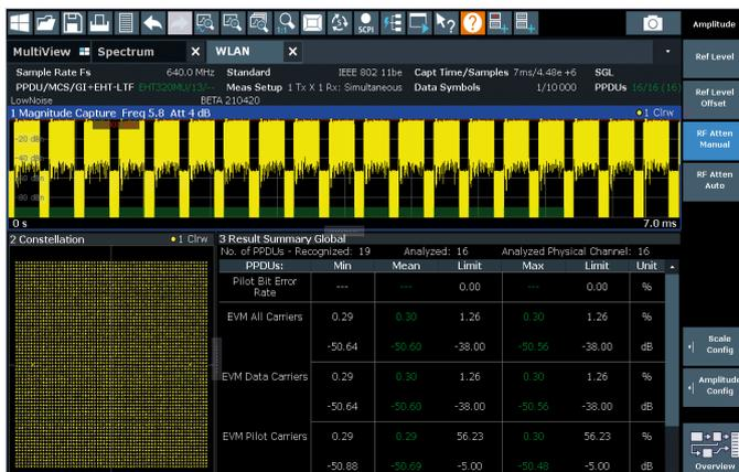
使用R&S®FSW-K149高速率脉冲重复频率超宽带测量应用的HRP UWB信号分析。
