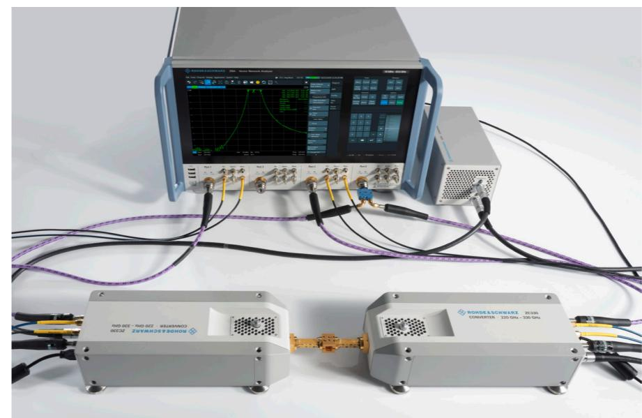
1台のR&S®ZNA43および2台のR&S®ZC330 ミリ波コンバーターWM-864を使用したミリ波測定のセットアップ
