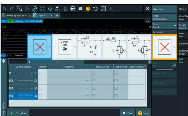
R&S®ZNAは、値の編集が可能な定義済み整合回路を取り揃えています。値を変更した場合、R&S®ZNAはただちに回路を再計算し、DUTを新しい回路にリアルタイムで埋め込みます。
