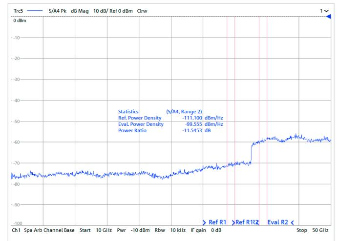
R&S®ZNA-K1 スペクトラム・アナライザ・オプション: 増幅器の振幅および位相圧縮測定(1 GHz、トップ)と、対応する高調波およびスプリアススペクトラム
