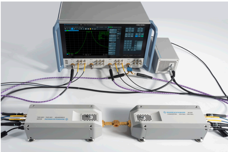
毫米波测量装置, 包括一个R&S®ZNA43和两个R&S®ZC330毫米波变频器WM-864
