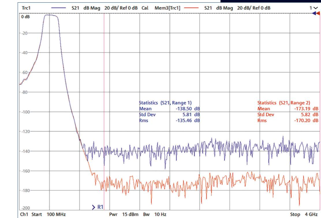
动态范围:最大规格输出功率条件下,无选件(蓝色迹线:10 Hz中频带宽时);
