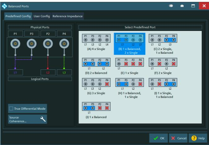
差分结构以及已用和未用端口可一键定义。选项卡支持用户灵活配置预定义的拓扑结构。
