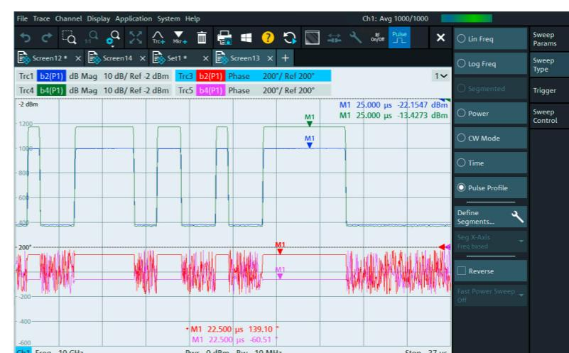
任意脉冲序列的脉冲包络测量。多个接收机的脉冲序列可同时进行测量。接收机具有相位相关性，不仅测量脉冲幅度，还能够非常稳定地测量脉冲相位。这样能够非常简单可靠地确定被测设备的相位偏差。
