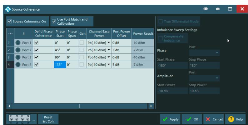
用于设定各端口的特定相位和功率的设置窗口。在自动的真实差分测量模式下,用户可以输入相位和幅度不平衡扫描的参数。
