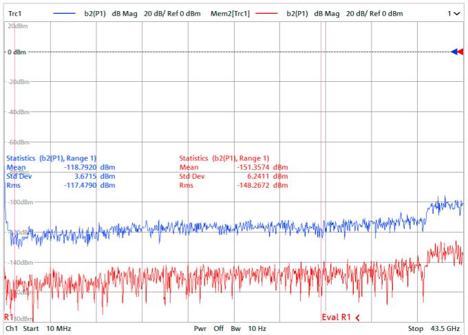
R&S®ZNA26/R&S®ZNA43接收机的灵敏度高达-150 dBm(频率下限,典型值,1 Hz中频带宽,直接信道接入/反向耦合器,接收机步进衰减器位于0 dB位置)。使用R&S®ZNAXx-B302和R&S®ZNAXx-B501前置放大器可进一步提高b1和b2接收机的灵敏度。
