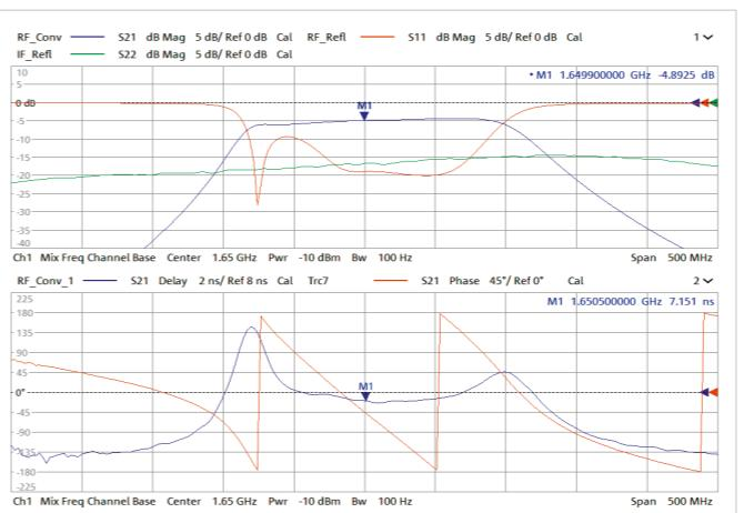
变频器测量结果包括回波损耗、变频损耗、相位和群时延
