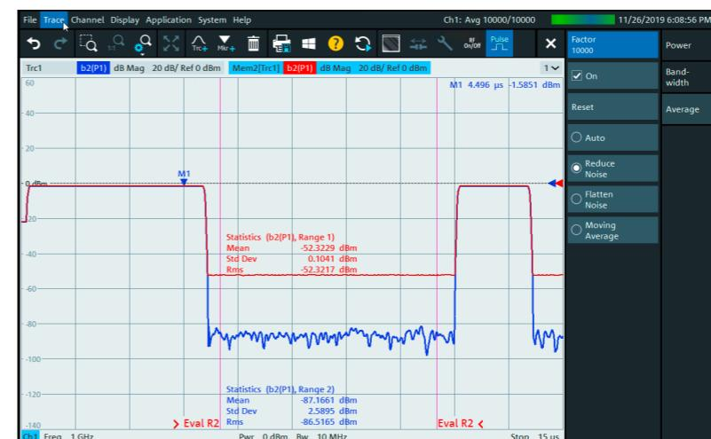
脉冲包络测量：宽带测量模式支持单次脉冲扫描，无需进行平均处理。平均(AVG)模式也可根据矢量平均实现低迹线噪声或高动态范围(高脉冲开关比)。红色迹线：AVG模式“平坦噪声”。蓝色迹线：AVG模式“降低噪声”。
