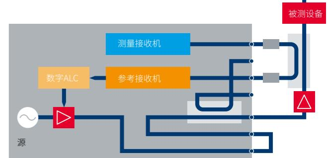
ALC操作：对于采用外部前置放大器和定向耦合器的高功率测试装置，可以控制信号源功率以匹配前置放大器输出功率。这种操作可以补偿漂移效应，确保非常准确稳定的输出功率。
