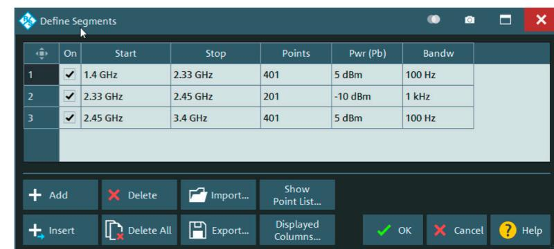
分段扫描能够针对扫描子分段定义不同的测试参数,例如定义滤波器阻带的高功率和窄中频带宽以提供高动态范围,以及定义通带的高中频带宽和窄频率步进以缩短测试时间和提供高分辨率。
