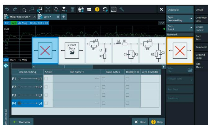
R&S®ZNA提供多种预定义匹配网络,并且可编辑网络元件数值。如果更改网络元件数值,R&S®ZNA将立即重新计算网络并将被测设备实时嵌入新网络。
