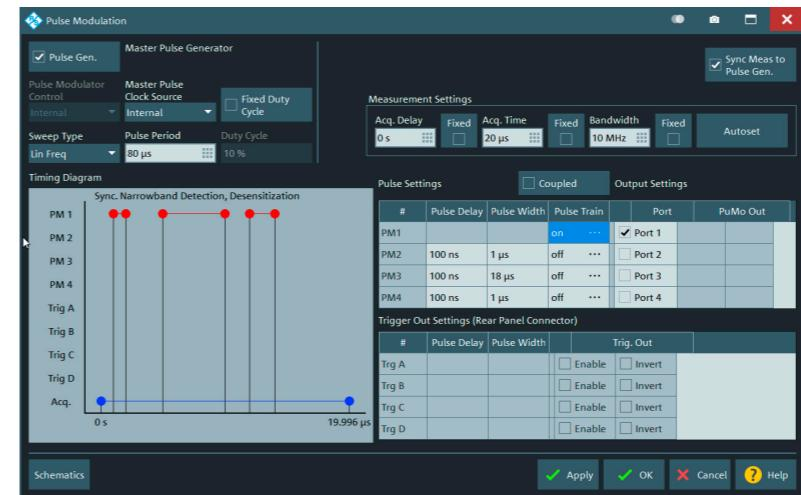
脉冲信号测量参数配置
