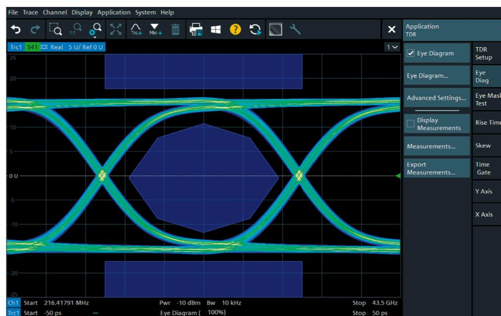
R&S®ZNA-K20选件提供多种信号完整性测量功能(例如包含模板的眼图),以便验证是否符合相关要求。它还可用于测定具有抖动或噪声的信号的传输特性。
