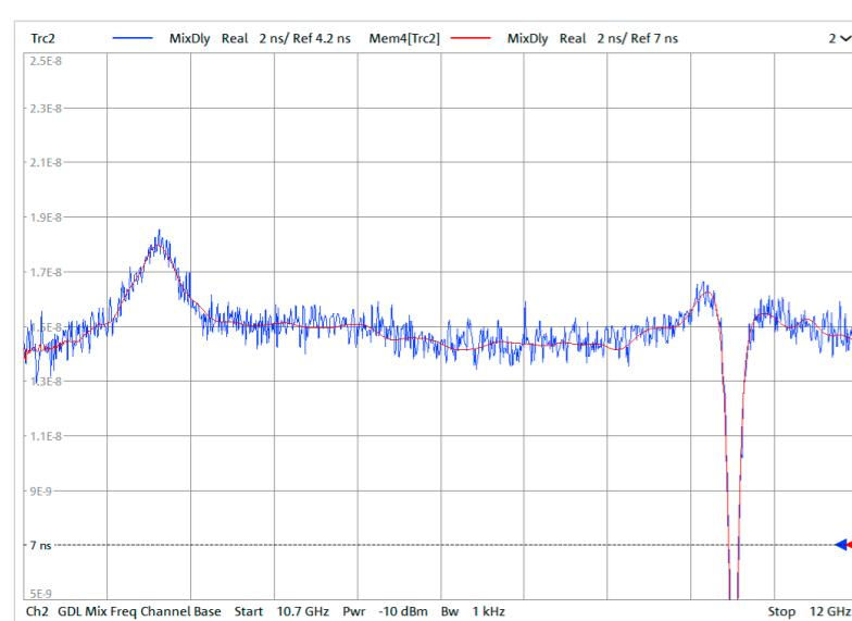
60 dB增益嵌入式本振变频器的群延时测量(两次测量显示为蓝色迹线和红色迹线,中频带宽均为10 kHz)。蓝色迹线:迹线噪声高,在信号源步进衰减器后采集低电平参考信号。红色迹线:迹线噪声减小,在信号源步进衰减器前采集参考信号,参考接收机处具有高信噪比。
