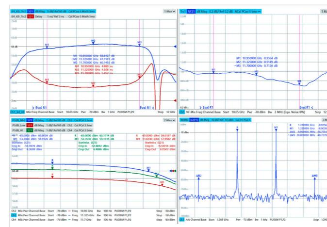
嵌入式本振变频器测试的示例结果屏幕：变频增益、群时延、噪声系数、压缩点、互调
