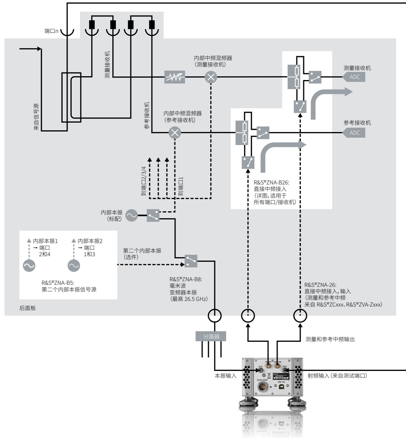
四端口R&S®ZNA67EXT连续扫描系统, 最高110 GHz
