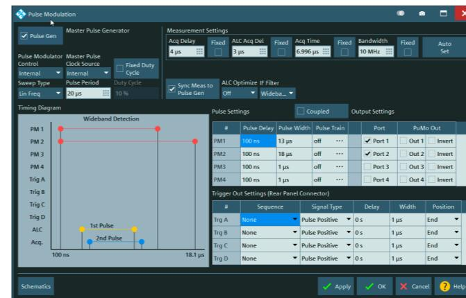
在脉冲条件下配置ALC测量，可以进行详细设置以匹配ALC和脉冲参数。例如，为了支持短脉冲，ALC控制和测量可以设为连续脉冲。
