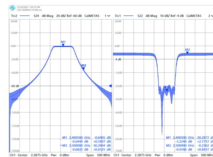
R&S®ZNA-K50(P)选件在S参数迹线中实时添加误差线,实时计算每次扫描的不确定度。
