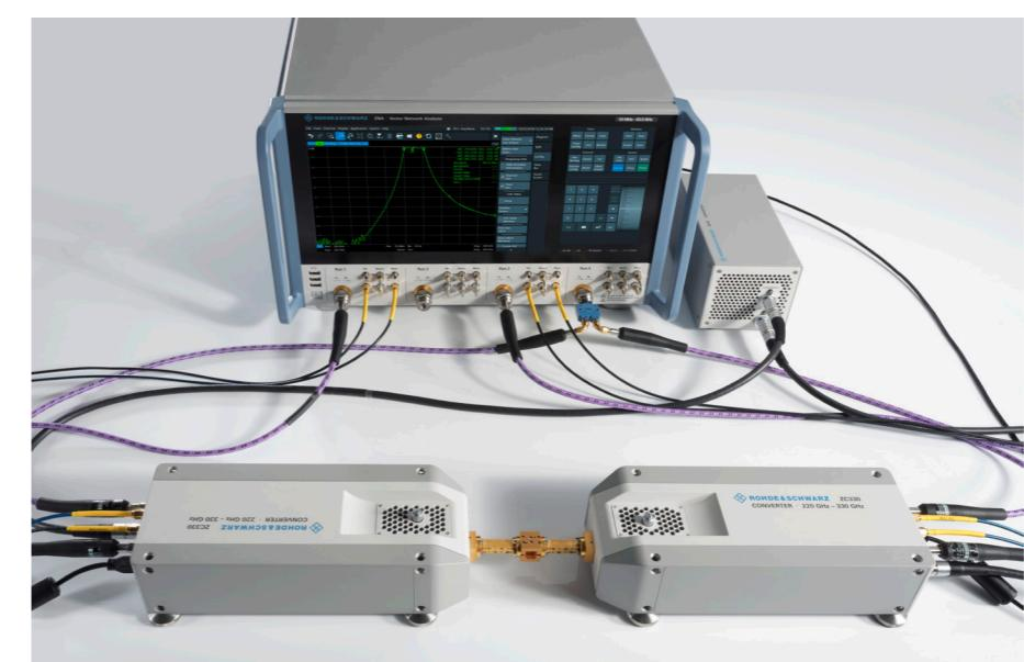
毫米波测量装置，包括一个R&S®ZNA43和两个R&S®ZC330毫米波变频器WM-864
