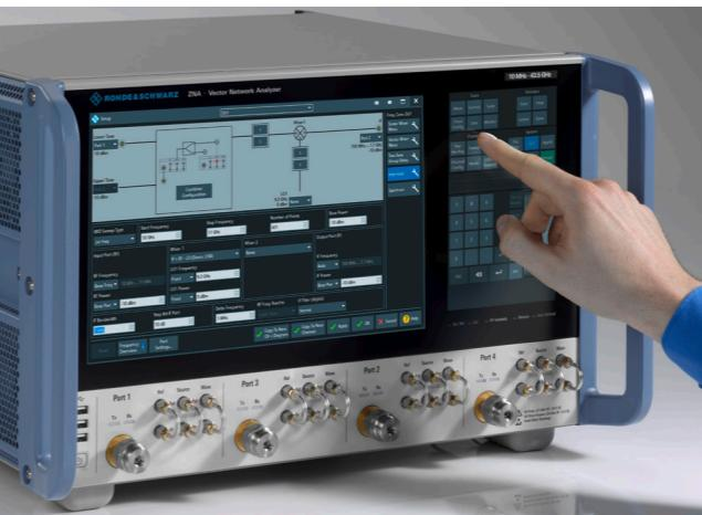
通过触摸面板控制R&S®ZNA。一体化对话框清楚显示所有关键参数,并可以跟踪整体测量配置,便于用户使用分析仪。
