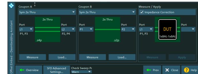
对于夹具内和PCB测试,罗德与施瓦茨提供基于样板的高级去嵌选件,并通过智能配置向导进行配置。
