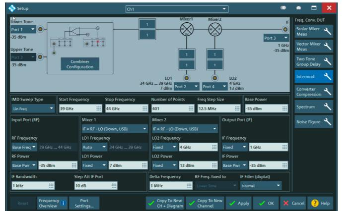
一体化对话框显示双变频接收机的互调测量设置
