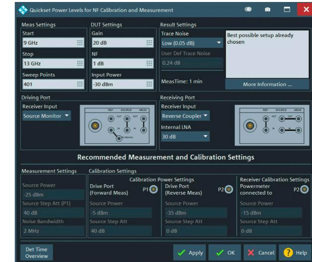
Quickset对话框用于以交互方式半自动配置合适的测试参数与R&S®ZNA硬件
