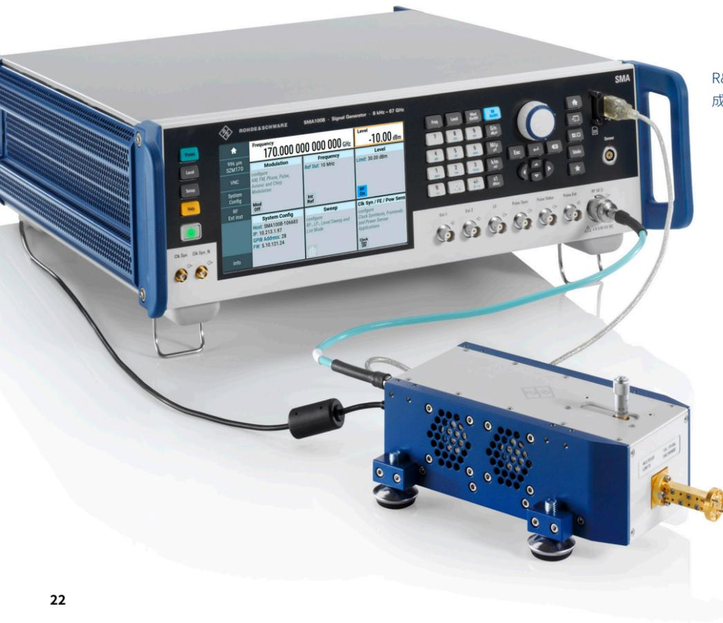
R&S®SMA100B和R&S®SZM170倍频器组成的测试装置：
