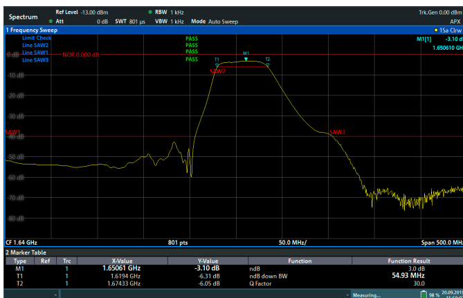
Измерение и оценка параметров ПАВ-фильтра (полоса пропускания «на n дБ ниже», добротность)
