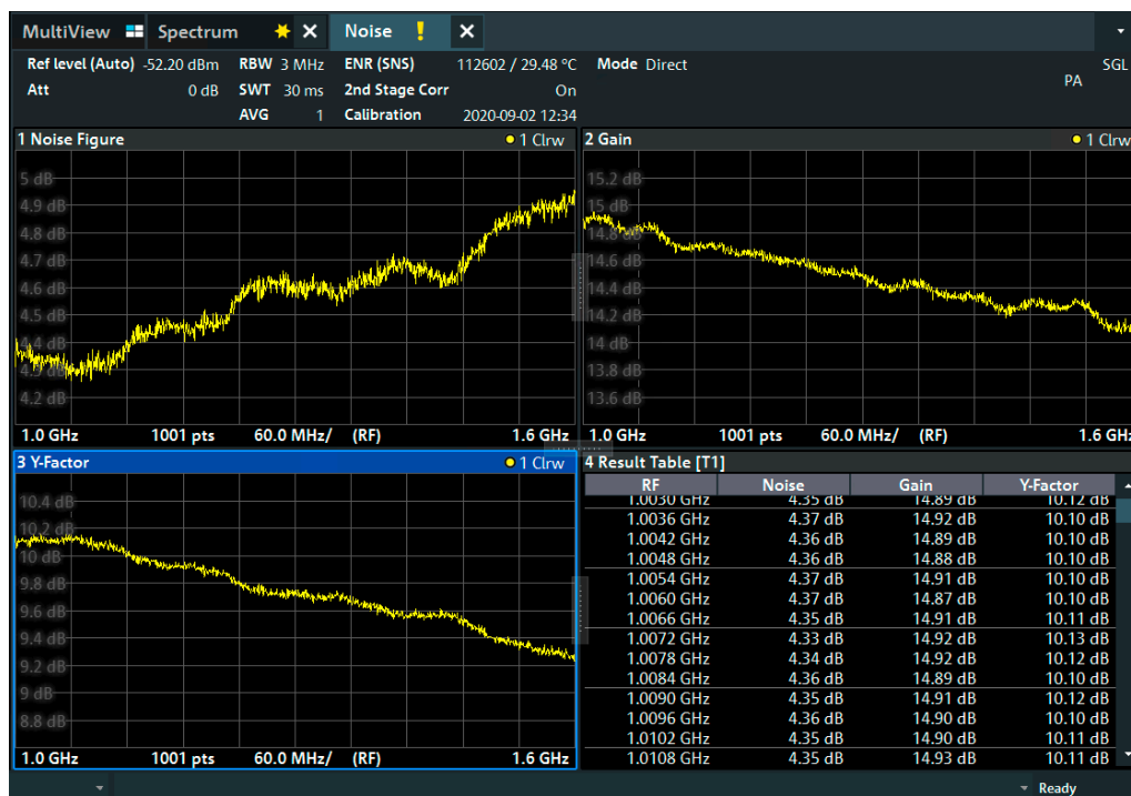
Representación simultánea del factor de ruido, la ganancia y el factor Y en función de la frecuencia, con una tabla de resultados en formato numérico
