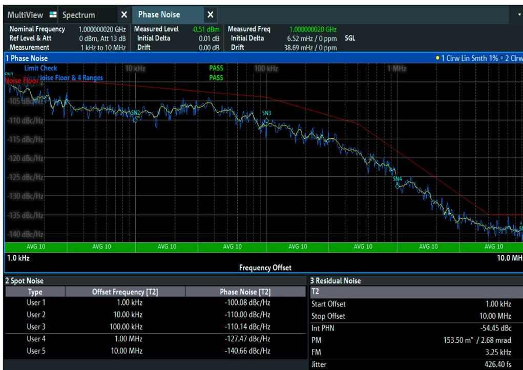
位相雑音測定+自動リミットチェック、スポットノイズ、残留ノイズ表示
