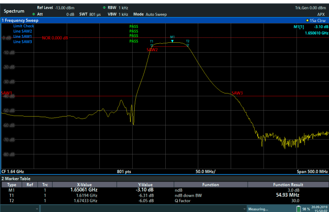
SAW滤波器测量和认证 (n-dB down带宽、品质因数)
