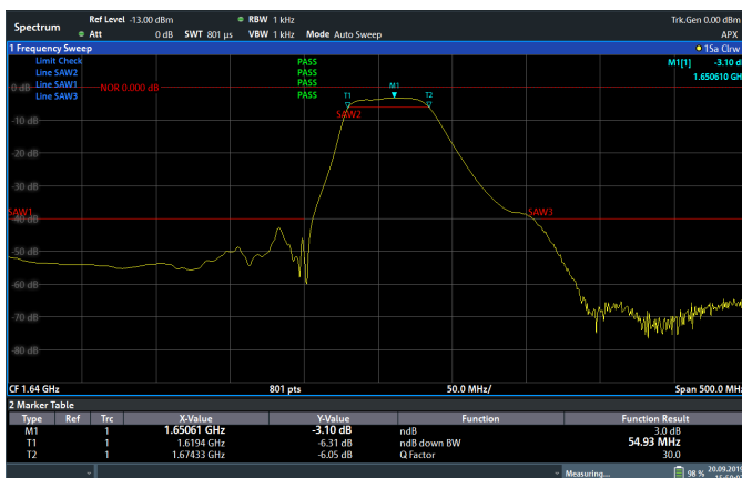
测量和认证SAW滤波器 (n-dB down带宽、品质因数)
