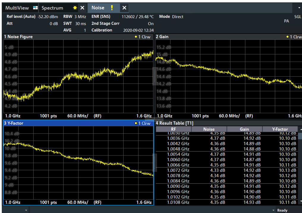
噪声系数、增益和Y因子与频率的同步视图，表格中包含结果数值
