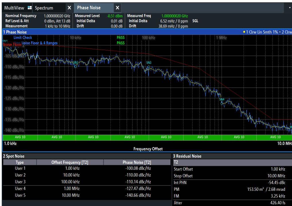
相位噪声测量、自动限值检查、点噪声和残余噪声指示
