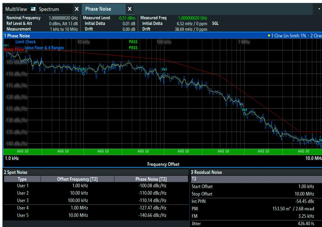
Mesure du bruit de phase plus vérification de limite automatique, indication de bruit ponctuel et de bruit résiduel
