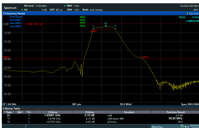
Messung und Qualifizierung eines SAW-Filters (n-dB-Down-Bandbreite, Gütefaktor)
