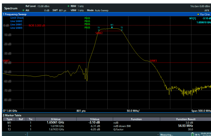
Messung und Qualifizierung eines SAW-Filters (n-dB-Down-Bandbreite, Gütefaktor)
