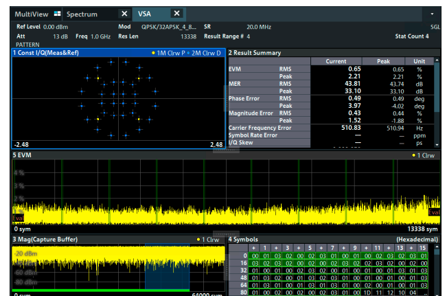
Demodulation eines DVB-SX2-Multi-Modulationssignals mit der Option R&S®FPL1-K70M (Option R&S®FPL1-K70 erforderlich)
