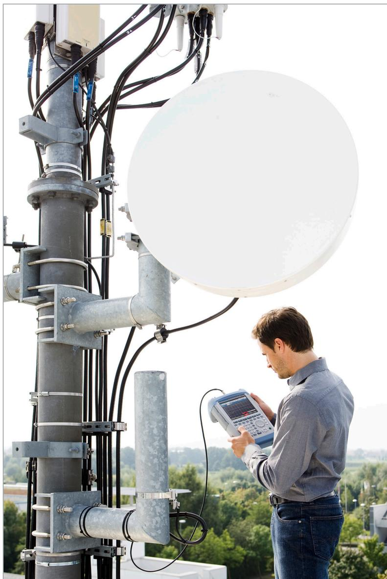
在安装和维护发射站时使用 R&S®FSH
