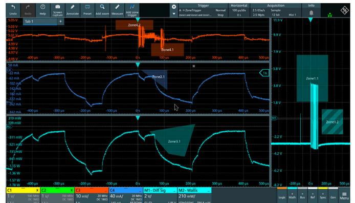
在射频传输过程中利用区域触发进行电源轨测量来隔离功耗事件
