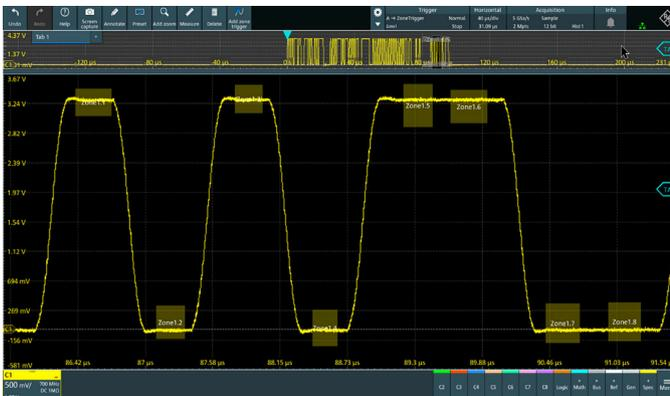
Utiliser le déclenchement sur zone sur des protocoles afin de déclencher sur une séquence spécifique de paquets
