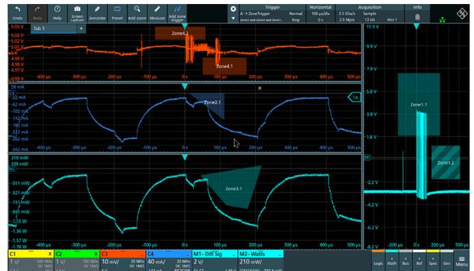
Mesures de rails d'alimentation avec le déclenchement sur zone pour isoler des événements de consommation de puissance au cours des transmissions RF
